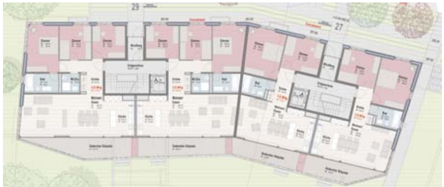
Abb. 32: EG-Grundriss Neubau (Plan Stand Baubewilligungsphase)
